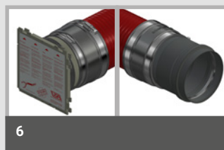
Seite 1: BKD150-K Seite 2: SM160 Erste Seite mit Dichtpackung zum Einbetonieren; Zweite Seite mit Steckmuffe zum Anschluss eines glattwandigen Rohres
